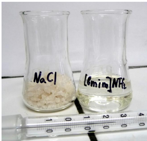
Рисунок 1 - Поваренная соль \text{NaCl} (слева) и ионная жидкость [\text{BMIM}]\text{NTf}_2 (справа) при температуре 27\text{ }^{\circ}\text{C} ; ИЖ остаётся жидкой при комнатной температуре, в отличие от типичной неорганической соли ( \text{NaCl} )
