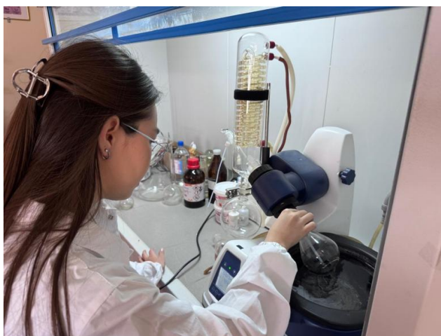
Рисунок 3 - Синтез 1-этил-3-метилимидазолия тетрафторборат [\text{Emim}][\text{BF}_4] на роторном испарителе.
